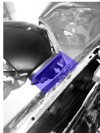
**Schritt 7:** Entfernen Sie nun die Spiegelkappe vom Spiegelgehäuse. Es gibt hier zwei Möglichkeiten: 1. Im Vorfeld wird das Spiegelglas entfernt. 2. Vorsichtig mit einem Karosseriewerkzeug die Kappe aufhebeln bis es sich vom Gehäuse trennt.
