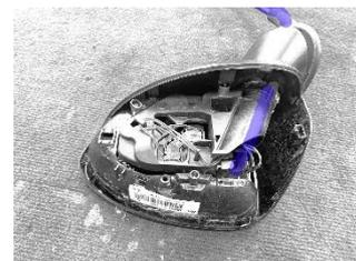
Schritt 9: Montieren Sie nun den zusammengesetzten Spiegel wieder an die Fahrzeurtür und befestigen diesen mit den 3 Schrauben. Das Kabel verlegen Sie parallel zur Spiegelelektrik bis zum weißen Stecker durch die Lautsprecheröffnung.
