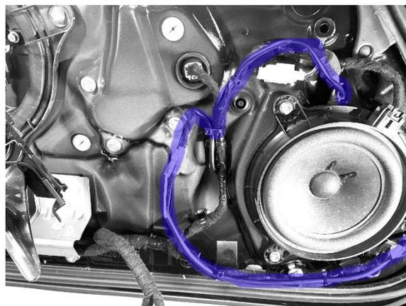
Schritt 14: Bevor Sie die Tür wieder in umgekehrter Reihenfolge zusammensetzen Prüfen Sie einfach anhand des Pannenblinkers, ob das Blinksignal in der Spiegelkappe ankommt. ggf. Prüfen ob Kabel verpolt sind.
