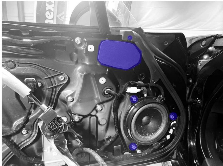
**Schritt 5:** Demontieren Sie die Führungsschiene des Seitenfensters an 3 Lösepunkten. Anschließend wird das Dreiecksfenster samt der Schiene nach oben aus der Tür herausgenommen.
