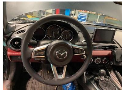
**Schritt 3:** Entfernen Sie den Sicherheitsstecker (Gelb) des Airbags mit Hilfe eines dünnen Schlitzschraubendrehers und entfernen Sie den weißen Multistecker zum Schleifring. Mit einer 21 Nuss entfernen Sie die Zentralmutter des Lenkrades. Anschließend können Sie das Lenkrad aus dem Fahrzeug entfernen.
