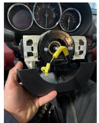
**Schritt 5:** Lösen Sie den Stecker unterhalb der Lenksäule.
