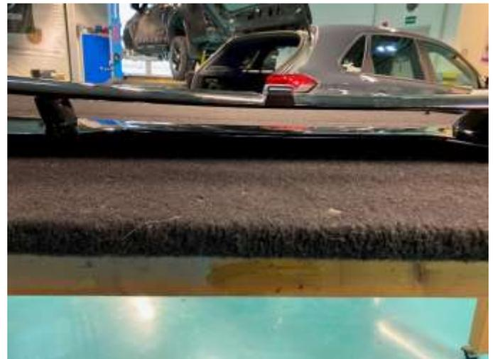
7. Mit Hilfe von Malerkreppband kleben Sie sich Hilfslinien an den Seiten des Spoilers auf um später die Bohrlöcher übertragen zu können. Optional kann mit angespitzten Madenschrauben diesen Weg umgehen und die Bohrlöcher direkt auf dem Lack durch gezieltes auflegen markieren. Messen Sie den Abstand der Löcher sorgfältig aus und übertragen diese dann auf den Spoiler. Bitte vor dem Bohren nachmessen und am Spoiler vergleichen.
