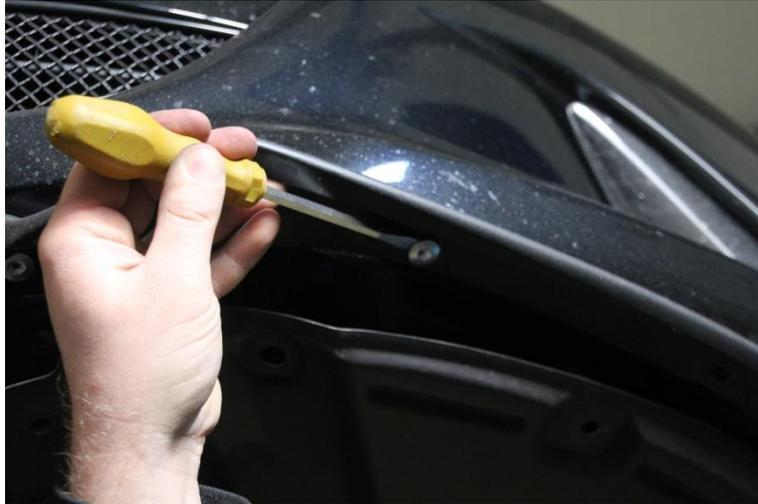
4. Anschließend die Nieten mit einem Schraubendreher & Hammer abschlagen Die Flaps sind zusätzlich noch gesteckt.
