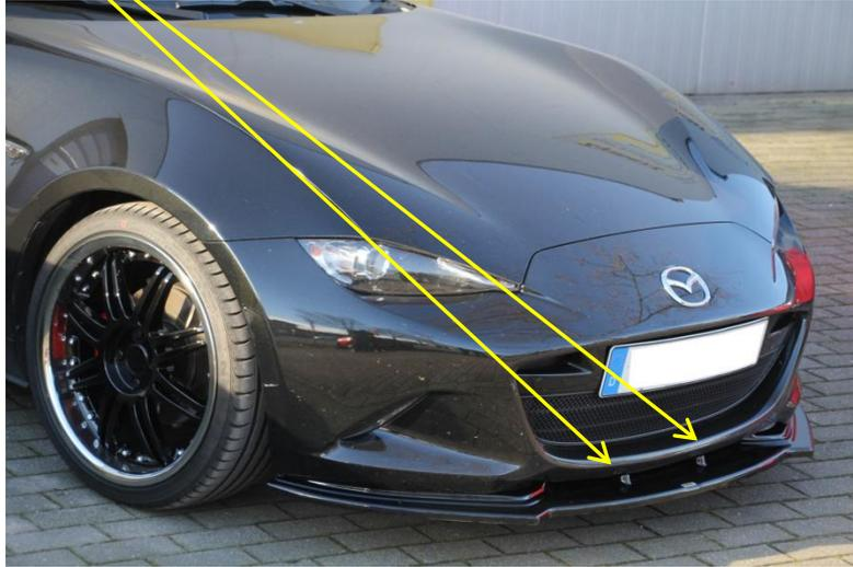
**11. Anschließend den Unterfahrschutz rechts & links montieren.**
