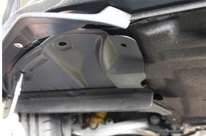
**2. Schrauben und Steckklammern lösen damit Rechts und Links und der Unterfahrschutz gelöst ist.**
