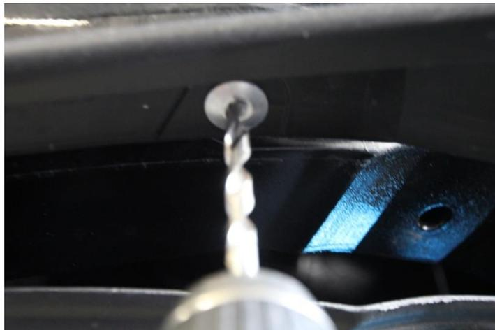
**3. Die originalen „Flaps“ werden demontiert. Dazu müssen die Nieten ausgebohrt werden. Ein 6- 8mm Bohrer empfiehlt sich hier.**
