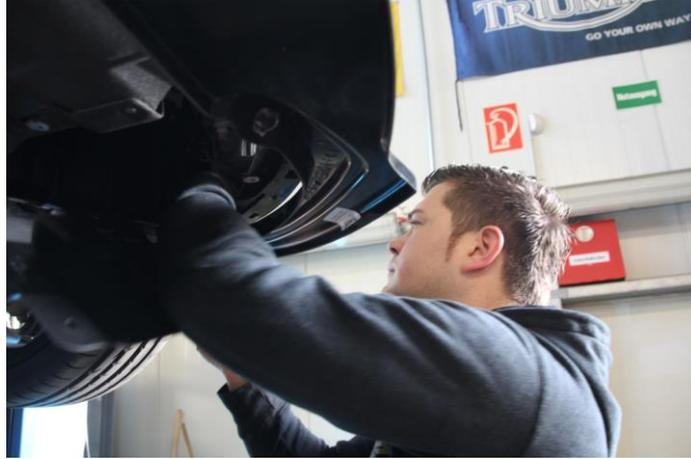
9. Verschrauben Sie mit den beigegefügt Schrauben den Frontspoiler von außen nach innen. Unterlegscheiben und Muttern werden von innen montiert.
