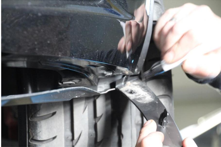
5. Die „Flaps“ verlaufen weiter in das Radhaus hinein. Hinter der Radhausverkleidung eine Schnittkante anzeichnen.
